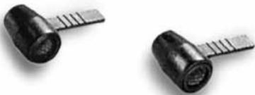
Рис. 6.10. Датчики ультразвукового сканера
