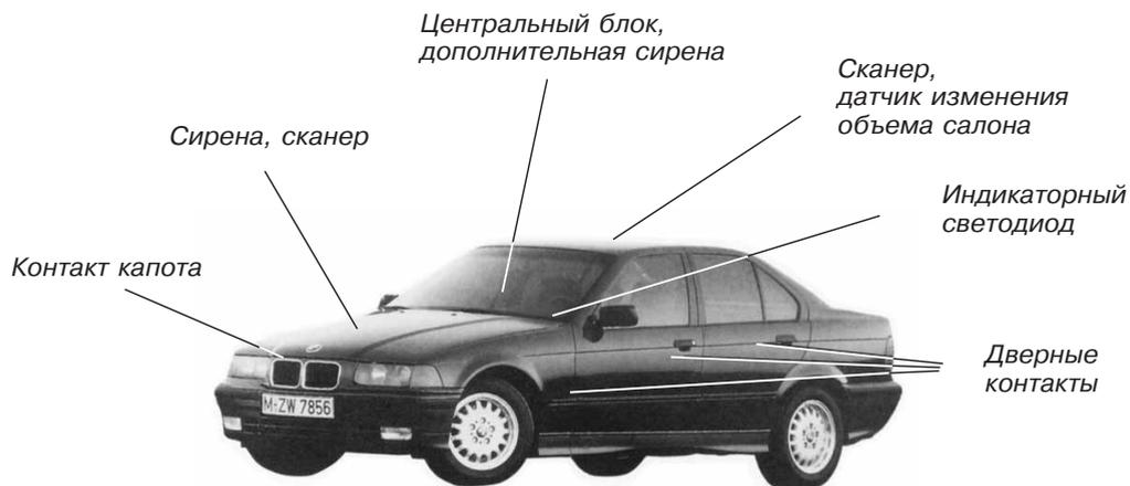
Рис. 6.8. Расположение блоков и датчиков в автомобиле
